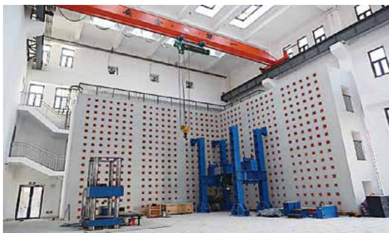
多通道电液加载系统 (重点实验室)
