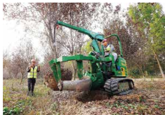
江淮植物园内工人正在驾驶挖树机作业
