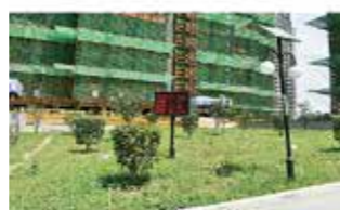
施工现场安装环境监测监控系统 实现对施工现场扬尘治理 环境空气质量进行实时在线监测
